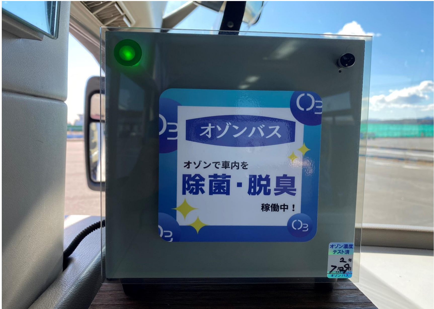
< オゾン発生装置 >
